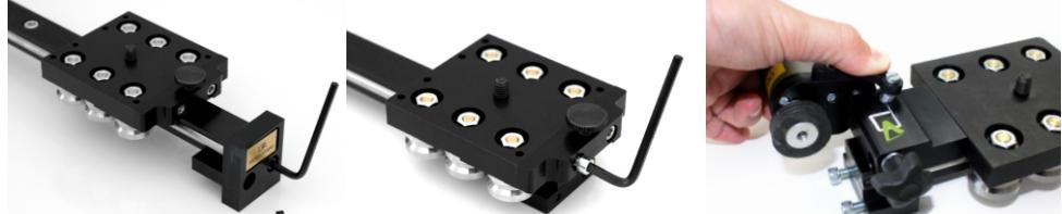
Вкрутите вспомогательный винт M6 x 10мм в левое монтажное отверстие на каретке слайдера (винт используется, что бы правильно расположить двигатель относительно каретки). Поднимите вверх и зафиксируйте зажимной ручкой [2] плечо двигателя с валиком и после этого переместите каретку к центру направляющей.
