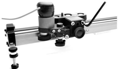
При использовании электропривода помните о необходимости разблокировки стояночного тормоза с установленным на нем двигателем HDN-ZN-2. Разблокируйте пластину и прижмите валик к направляющей слайдера. Если вы хотите осуществить видеосъемку без использования электропривода, поднимите и зафиксируйте пластинку с роликом. В этом положении каретка будет перемещаться свободно.
